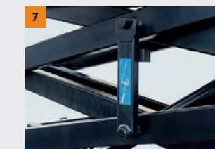
Braços de apoio: Para proteger o operador quando ele estiver fazendo trabalhos de reparo ou manutenção
