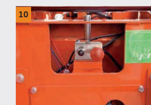
Válvula de liberação manual: Quando a máquina não puder se mover, você pode empurrar a máquina depois de pressionar esta válvula
